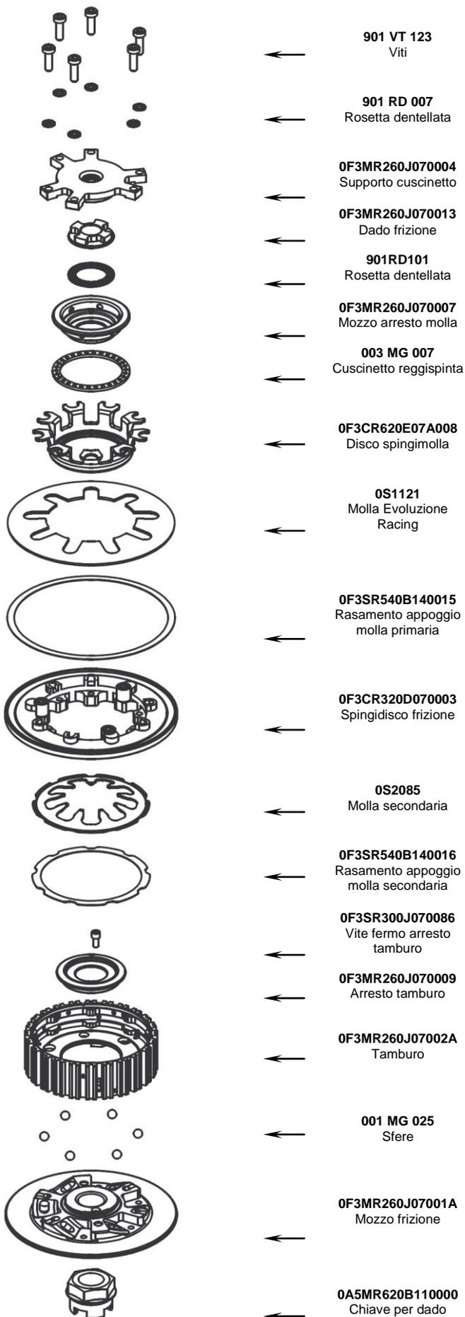
Il gruppo mozzo/tamburo, viene fornito pre-assemblato. **IN CASO DI NECESSITA'**, per eseguire una ispezione dello stato delle rampe, seguire la PROCEDURA SMONTAGGIO GRUPPO MOZZO/TAMBURO indicata più in basso.
