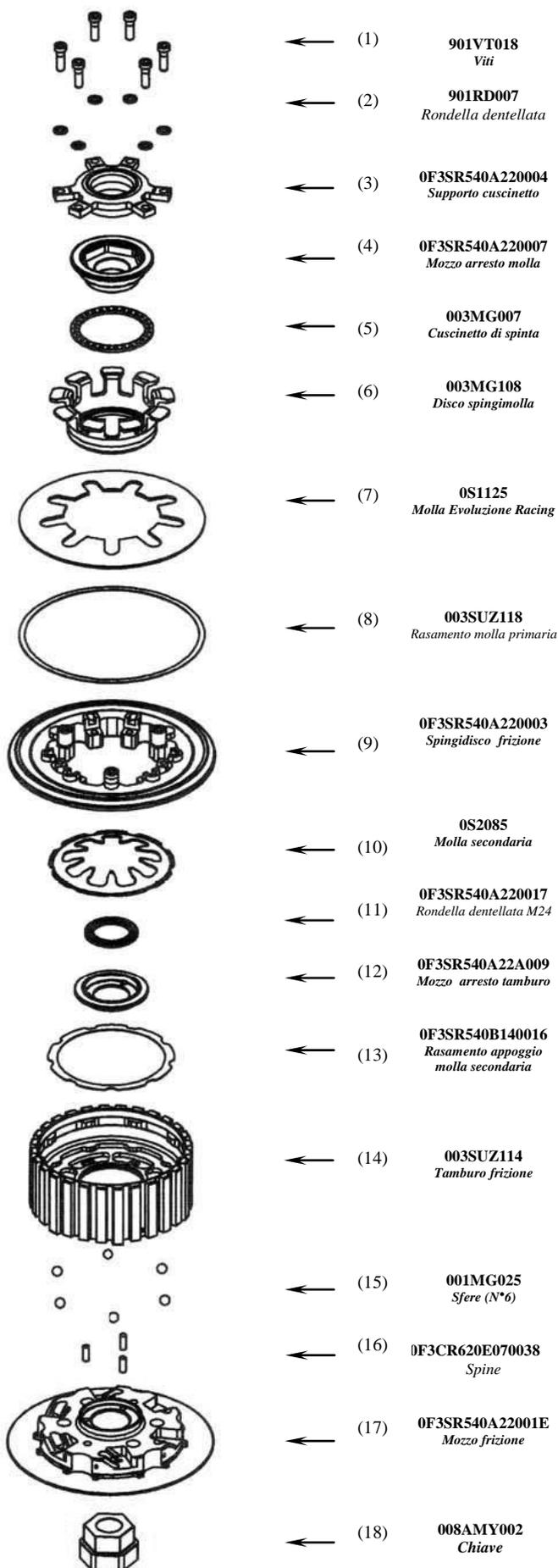
Collocare le 6 sfere (15) al fondo delle scanalature del mozzo (17) con una piccola quantità di grasso. Quindi fissare con una vite M6x1 il tamburo (14) sul mozzo (17) in posizione di riposo.
