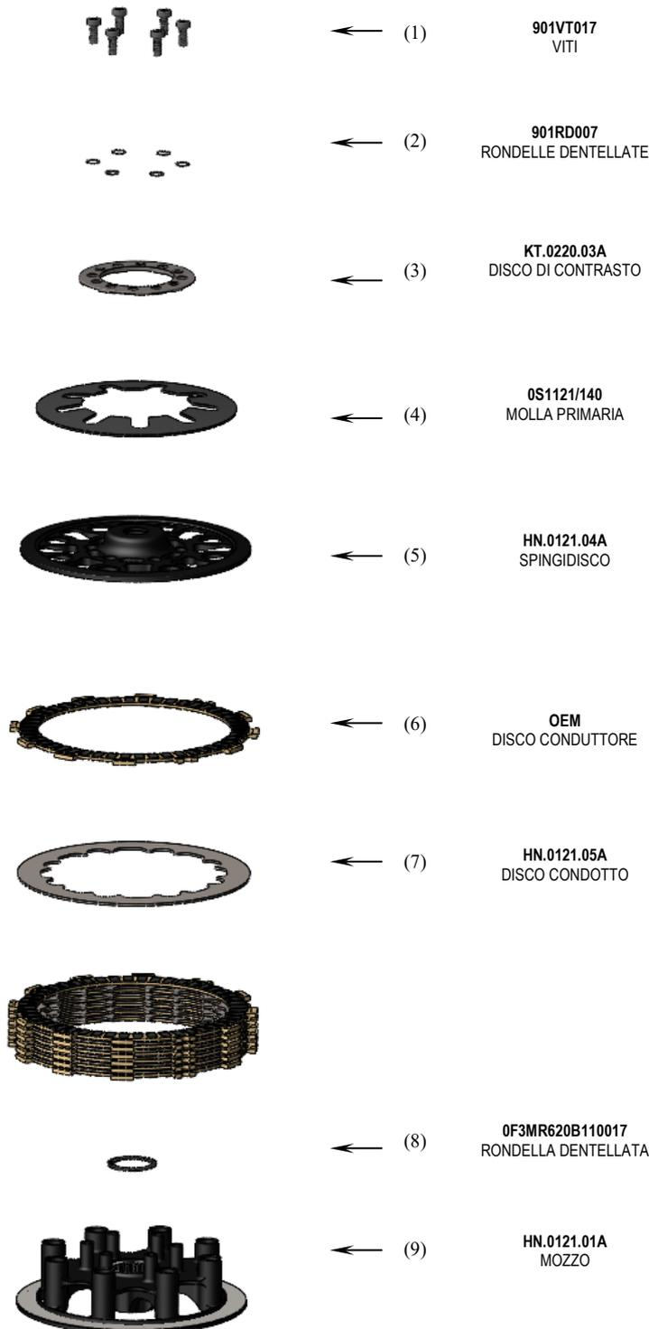
Il funzionamento della frizione è strettamente correlato all'altezza del pacco dischi. E' necessario dunque misurare il pacco dischi prima del montaggio. Dalla frizione originale prelevare solo i dischi conduttori, quindi assemblare il pacco dischi utilizzando i dischi condotti (7) forniti nella confezione ed effettuare la misurazione.
