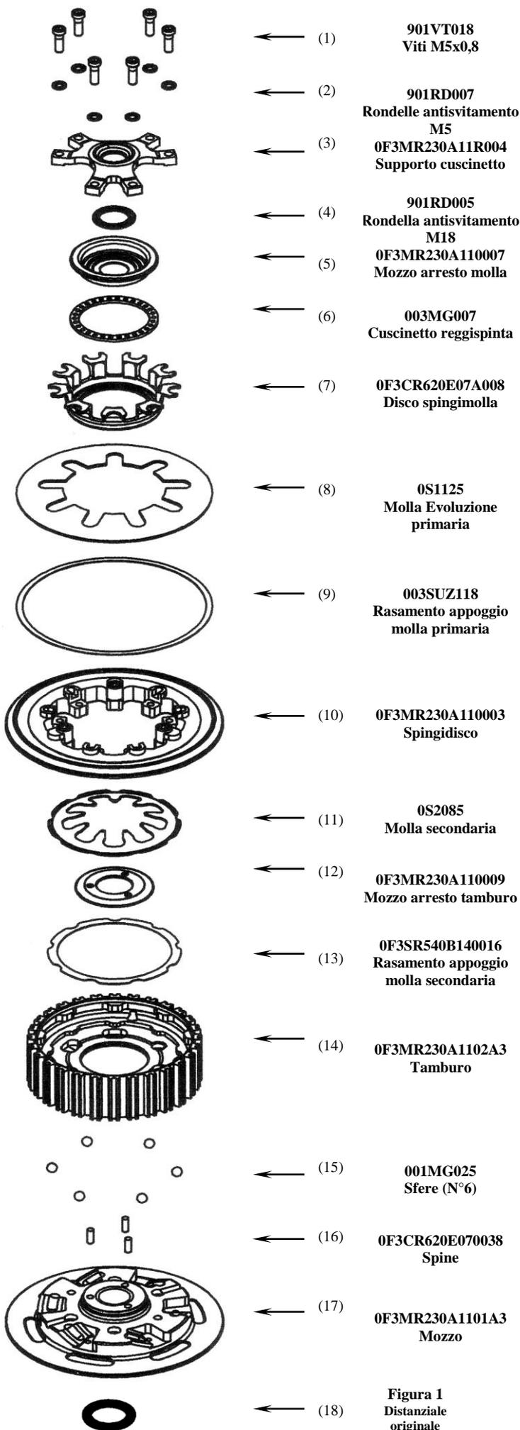
Premontare il gruppo mozzo: collocare le 6 sfere (15) al fondo delle scanalature del mozzo (17) applicando una piccola quantità di grasso, quindi con una vite M6x1 fissare il tamburo (14) sul mozzo (17) in posizione di riposo.
