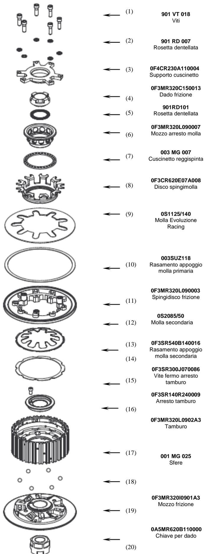
Il gruppo mozzo/tamburo, viene fornito pre-assemblato. **IN CASO DI NECESSITA'**, per eseguire una ispezione dello stato delle rampe, seguire la PROCEDURA SMONTAGGIO GRUPPO MOZZO/TAMBURO indicata più in basso. Inserire il gruppo mozzo/tamburo sull'albero primario. Eventualmente, per agevolare ulteriormente l'operazione, è possibile fissare il tamburo (0F3SR450D15002B) sul mozzo (0F3SR450D15001B), in posizione di riposo, con una vite M6x1.
